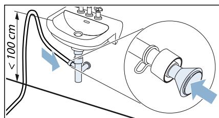
Îmbinarea trebuie asigurată cu un colier de furtun (interval de prindere 12-22 mm, magazine de specialitate).
