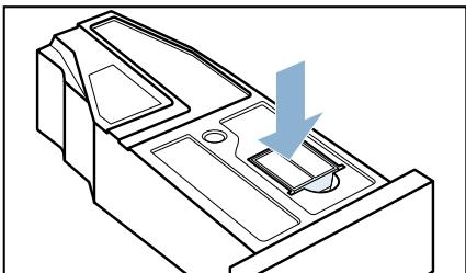
**12.** Introduceți rezervorul de apă de condens până la blocare.
