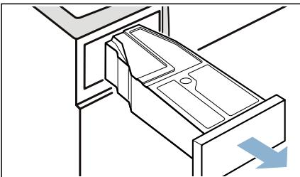
8. Rotiți rezervorul de apă de condens la  $180^{\circ}$  pe partea inferioară și îndepărtați dopul introdus.
