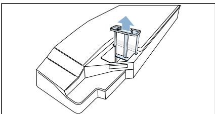
11. Așezați filtrul în cavitatea pentru rezervorul de apă de condens.
