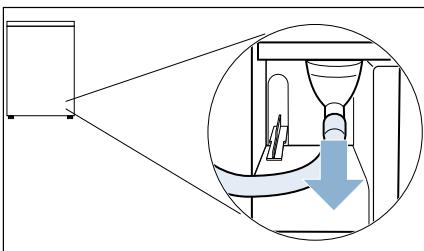
**Indicație:** La livrarea aparatului, furtunul pentru apă condensată este fixat pe duze.
