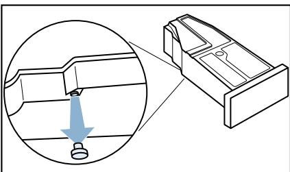
9. Rotiți din nou rezervorul de apă de condens la  $180^{\circ}$  și plasați dopul în cavitatea din partea superioară a rezervorului de apă de condens.
