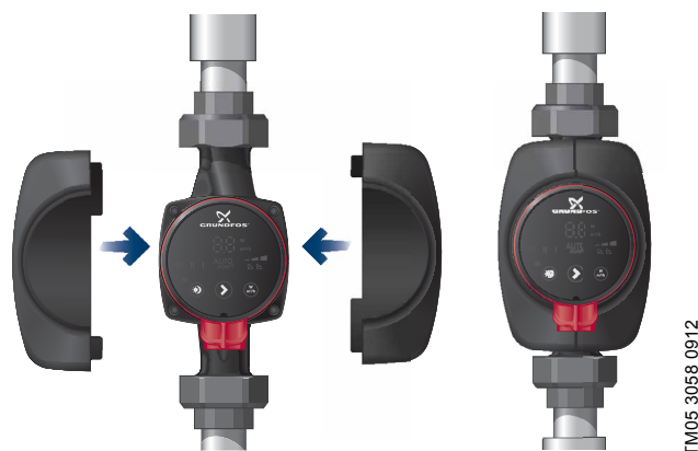
Fig. 10 Izolarea carcasei pompei
