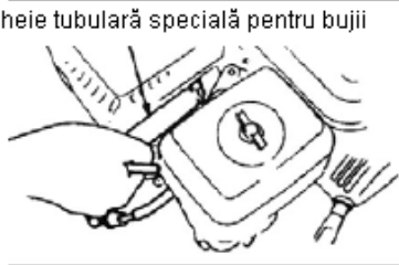
Cheie tubulară specială pentru bujii
