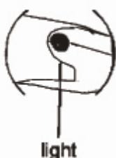
Cand masina functioneaza in conditii normale , becul periilor carbon este verde. Verificati frecvent periile carbon. Cand becul este de culoare rosie trebuie sa inlocuiti periile. Meninteti periile carbon curate. Amandoua peri carbon trebuie sa fie inlocuite in acelasi timp. Folositi peri carbon identice.
