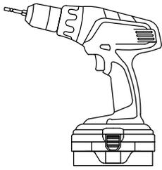
! Se foloseste bormasina cu reglare de presiune. Cuplul de strangere trebuie sa fie reglat corespunzator. Folosirea sa este interzisa la montajul camelor.
