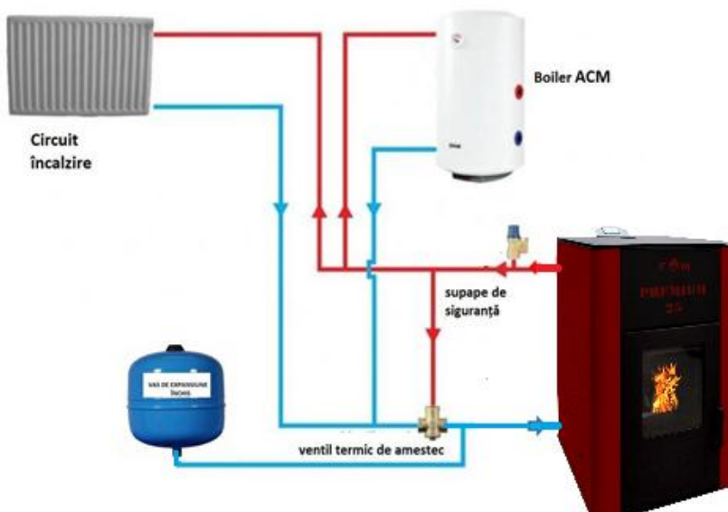
Schema simplificată de legare a termosemineului la instalația de încălzire
