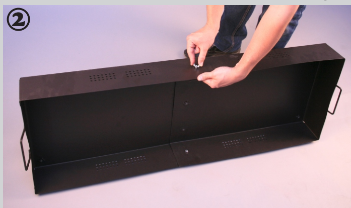
2. Fixăm componentele cutiei cu ajutorul șuruburilor și a piulițelor din dotare
