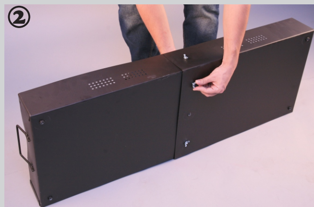
2. Fixăm componentele cutiei cu ajutorul șuruburilor și a piulițelor din dotare
