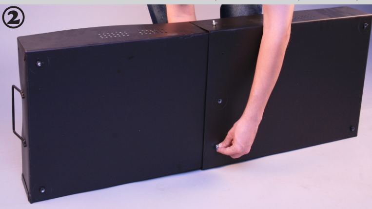
2. Fixăm componentele cutiei cu ajutorul șuruburilor și a piulițelor din dotare
