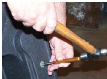
Fig. 3 Echipamentul necesar gauririi (dorn 8 mm + ciocan usor)
