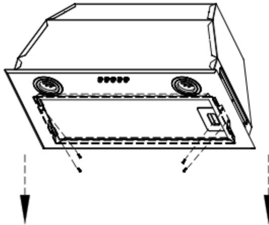
2. Așezați hota în corpul de mobilier cu ajutorul a 12 șuruburi.
