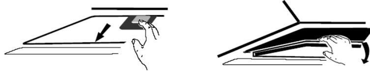
Așezați filtrul de carbon pe partea laterala a motorului și rotiți spre dreapta. Repetați aceeași operațiune la celălalt capăt cu un al doilea filtru de cărbune. Asadar, pentru fiecare hotă decorativă aveți nevoie de 2 filtre de carbune cate unul pentru fiecare parte a tubinei motorului.
