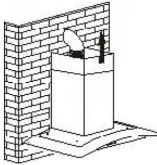
Măsurați pentru a stabili înălțimea corespunzătoare și faceți două găuri cu diametrul de 8 mm pentru a fixa panoul II. Prindeți și fixați panoul superior cu două din șuruburile furnizate.
