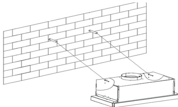
Fixați hota cu șurubul de siguranță. Cele două valve de siguranță sunt poziționate pe carcasa posterioară, cu diametrul de 6 mm.
