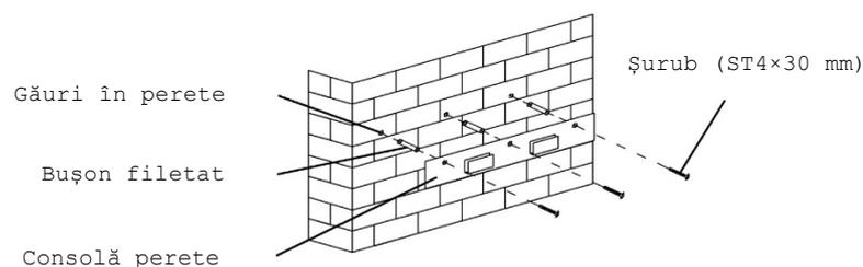
Faceți două găuri suplimentare cu diametrul de 8 mm și fixați șuruburile de prindere și diblurile corespunzătoare pentru a prinde hota pe perete.
