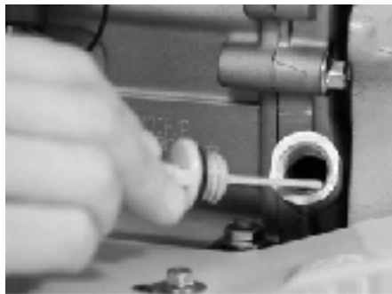
Fig. 4 – Verificarea nivelului de ulei al transmisiei
