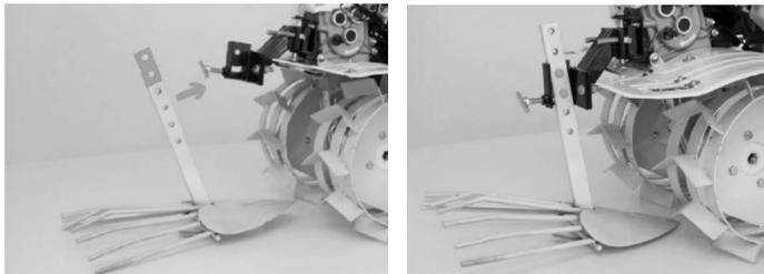
1. Se montează adaptorul de accesorii și se fixează cu bolț.
