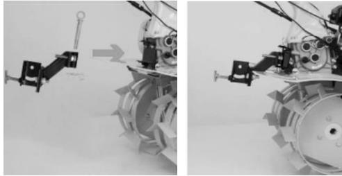
1. Se montează adaptorul de accesorii și se fixează cu bolț.
