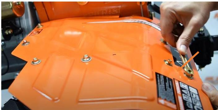
Se montează extensiile aripilor și se fixează în șuruburi.
