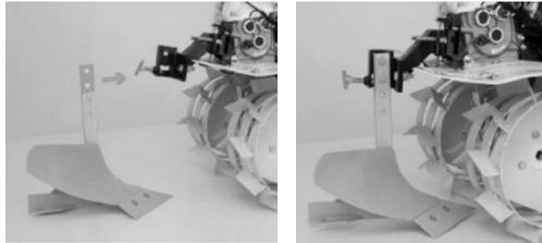
2. Se cuplează plugul pe adaptor și se fixează cu două șuruburi.
